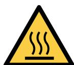
Risque de brûlure dû aux pièces de raccordement brûlantes!
